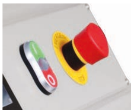
Control de encendido Apagado de emergencia
